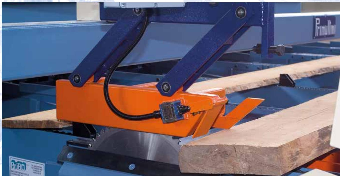
montiert und werden durch die Kopfbewegung zugestellt. Die Hilfsägeblätter sind auf Buchsen montiert, die über die Hauptwelle laufen. Auf den Buchsen kann ebenso eines wie mehrere Sägeblätter montiert werden.
